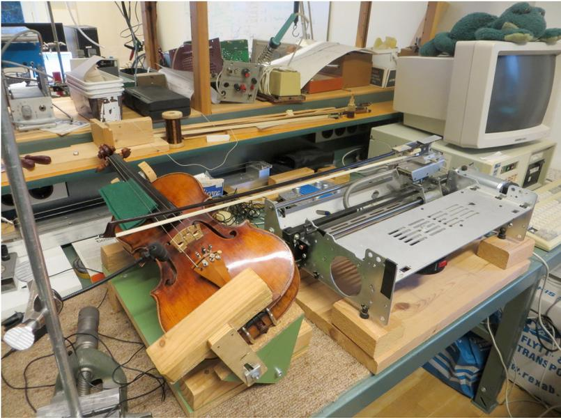
Abb. 75, Bowing machine (Streichmaschine) vom Department of Speech, Music and Hearing an der Royal Academy of Technology in Stockholm, hier mit einer eingespannten Violine.
